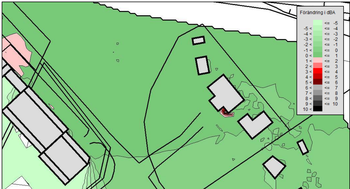
Figur 8. Utdrag ur bilaga 4. Skillnad i dBA mellan nollalternativ och fasader beklädda med ca. 50 % ljudabsorbent.
